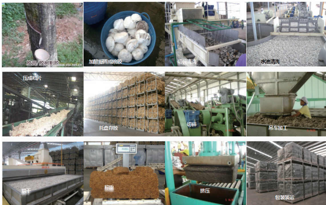
图2 20号标准胶生产工艺全过程
